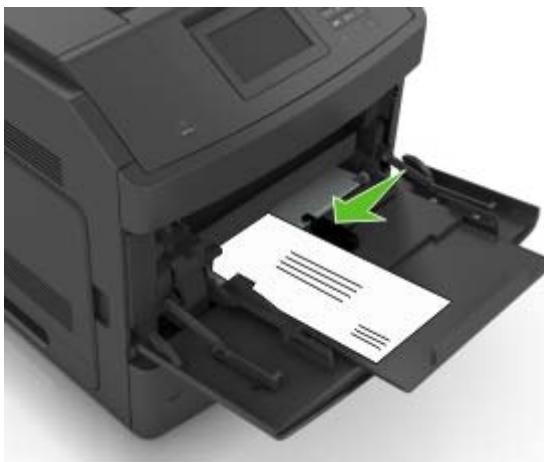
**Attention — Dommages potentiels :** n'utilisez jamais d'enveloppes avec timbre, agrafe, fermoir, fenêtre, revêtement intérieur couché ou bande autocollante. Ces enveloppes peuvent endommager sérieusement l'imprimante.
